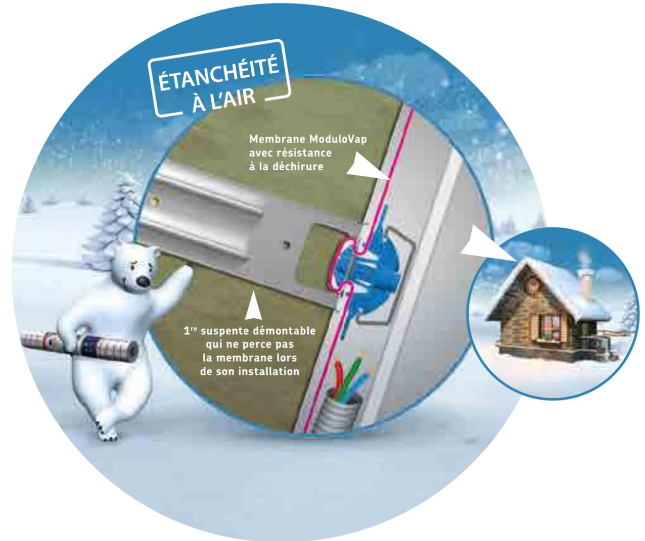
La seule suspente démontable qui permet de passer les gaines devant la membrane, sans la percer !
