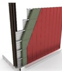
\*Les lèvres sont des appuis présents sur les plateaux de bardages, permettant la fixation du bardage extérieur. Ces lèvres peuvent être "droites" ou en "en caissons". CLADURSA est compatibles avec les 2 profils.
