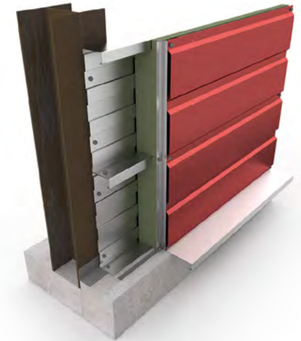
Exemple de solution avec ossature intermédiaire et avec appui sur la longrine
