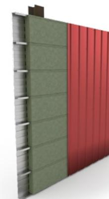
La peau extérieure est fixée aux lèvres de plateaux grâce à la pose des vis entretoises. Les vis entretoises créent un écartement laissant ainsi l'isolant non comprimé.
