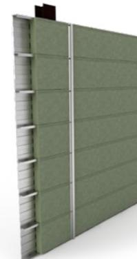
Après préperçage des montants (Z ou Oméga), ces derniers sont fixés sur chaque lèvre de plateau à l'aide des vis entretoises. La mise en œuvre est détaillée dans l'Atex.
