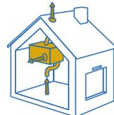
Lorsqu'elle est associée à une bonne isolation, la ventilation mécanique contrôlée permet le renouvellement de l'air nécessaire au bien-être et à la santé des habitants ainsi que l'évacuation de la vapeur d'eau excessive.
