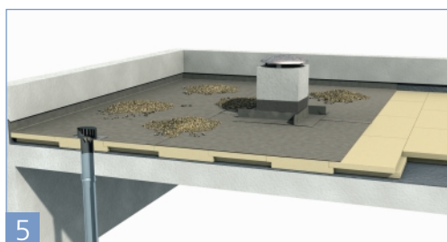
5 Pendant la pose du non tissé, ne pas oublier de le lester avec des gravillons, afin d'éviter les soulèvements provoqués par le vent.
