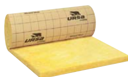
URSA PRK 35 Pavillon : ép 75 mm R = 2,10 ép 85 mm R = 2,40 ép 100 mm R = 2,85 ép 120 mm R = 3,4
