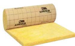
URSA PRK 41 HR R : ép 75 mm R = 2,30 ép 85 mm R = 2,65 ép 100 mm R = 3,10 ép 120 mm R = 3,75 ép 140 mm R = 4,35 ép 160 mm R = 5,00
